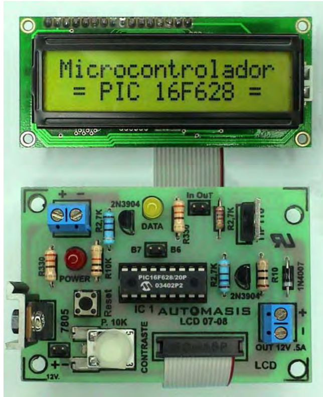
Figura 5.5.1.8. Fotografía de una tarjeta que controla un LCD 2x16 el cual posee un PIC16F628 que se encarga de enviar los datos y además enciende el backlight a través de un transistor 2N3904 dispone además:
