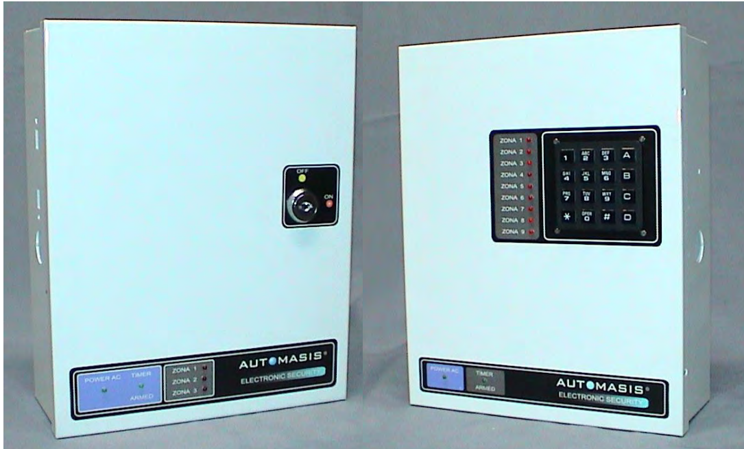
Figura 7.10.8. Fotografía de paneles de una alarma de 3 zonas y otra de 9 zonas con teclado.
