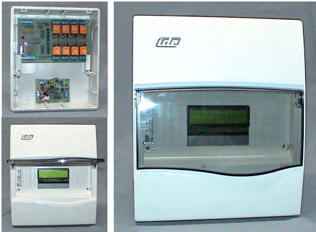
Figura 7.10.9. Fotografía de un PLC con LCD fabricado en una caja de breakers de plástico.
