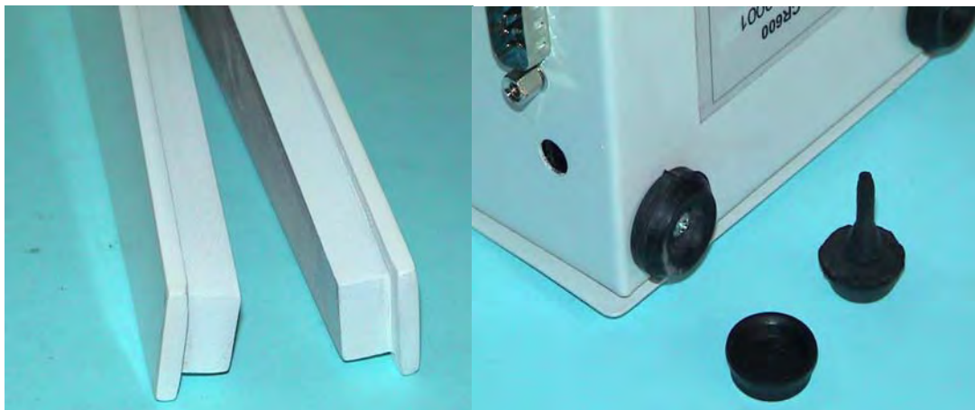
Figura 7.10.12. Chasis de una fuente de poder construida con madera y tool doblado, para las patitas se puede utilizar los cauchos automotrices que se utilizan como topes para las puertas.
