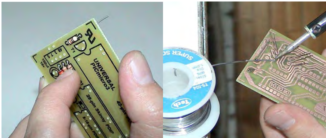
Figura 7.9.6. Sujete la resistencia con la uña, coloque el alambre de soldar al filo de una mesa y sin soltarlo empiece a soldar.
