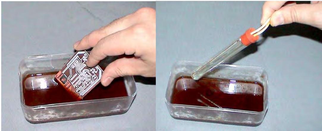
Figura 7.5.2. Introduzca la placa virgen en la solución ácida, si el ácido ya ha sido utilizado varias veces y tiene poca acción, introduzca el calentador para peceras.
