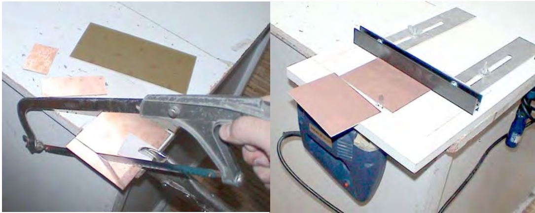
Figura 7.3.1. Paso 1. cortar la placa de 69 x 50 mm con una sierra o una caladora, esta última les permite cortes más rápidos y perfectos.
