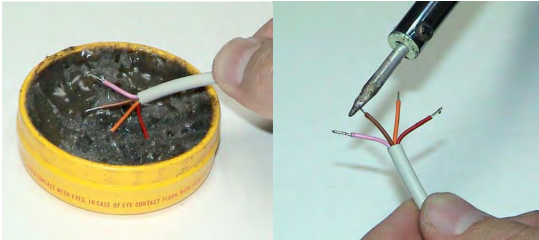
Figura 7.9.9. Introduzca las puntas del alambre en la pasta de soldar y luego estáñelo con el caudín previamente cargado de suelda.
