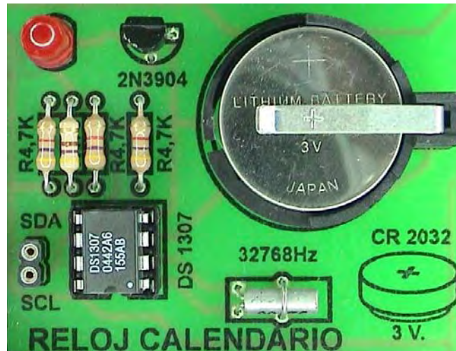
Figura 5.9.13.3. Fotografía de un módulo RTC del entrenador experto de PIC'S EE-02.
