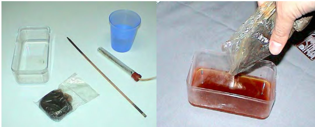
Figura 7.5.1. Materiales a utilizar, a la derecha mezcla del cloruro férrico con el agua.
